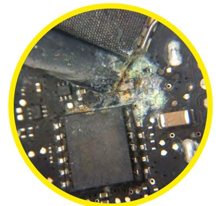
**Flüssigkeitsschäden hinterlassen Korrosionsspuren, welche die Werkstatt je nach Material manchmal entfernen kann**
