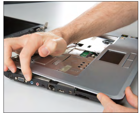
Die Clip-Verbindungen, welche die Gehäuseränder zusammenhalten, sind empfindlich und schnappen leicht wieder zu
